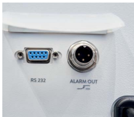
Interface RS 232 en série et contact alarme
